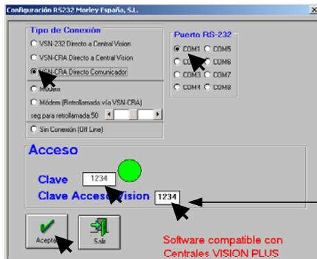
Clave interna de acceso al comunicador (Debe coincidir con la clave interna de la central a la que se conecte)
