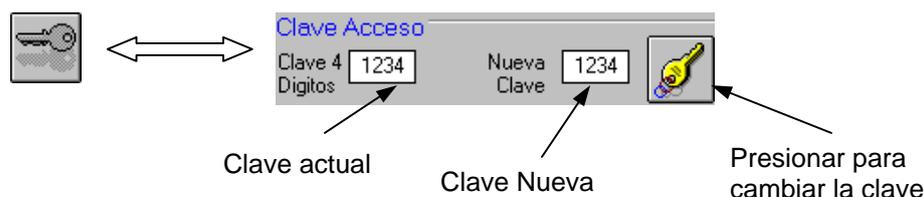
Para modificar la clave interna de la central en la pantalla de cambio de clave, sitúe el cursor sobre el campo de Nueva Clave y teclee la nueva clave deseada y presione el botón cambiar clave.
