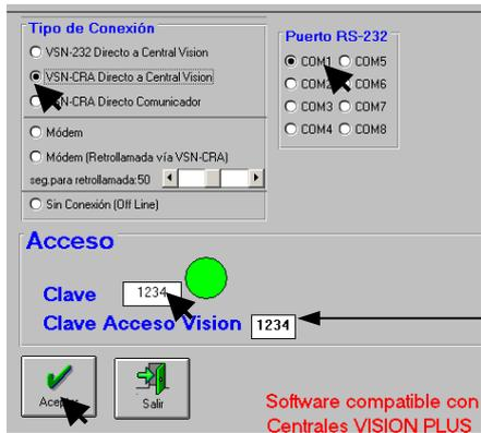
Clave interna de acceso a la central (Debe coincidir con la clave interna del comunicador)
