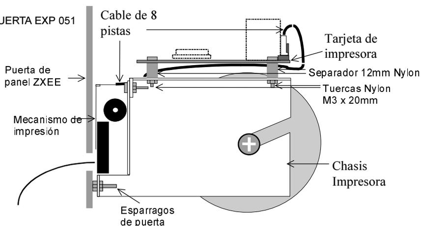
Para montar la impresora se debe cortar cuidadosamente con una cuchilla desde el interior de la puerta, la parte del panel que tapa la ranura de salida de impresión y colocar el adhesivo de la ranura, suministrado con la impresora, en la parte frontal del panel, teniendo especial cuidado en no obstruir la salida de papel.
