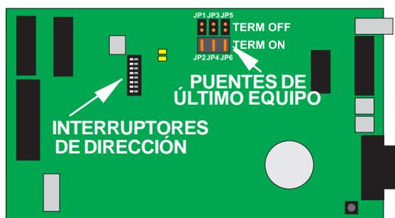
Figura 10 - Interruptores de dirección y puente de posición del equipo
