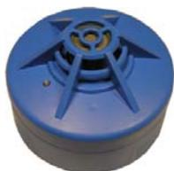
O detector VSN-CO é o dispositivo pontual de medida de concentração de monóxido de carbono. A central interroga a concentração de cada um dos detectores ligados e configurados na linha de zona. Graças à identificação pontual de cada equipamento na zona, a unidade controla a presença de todos os equipamentos ligados e o estado operativo dos mesmos e da linha de comunicações.
