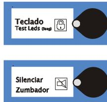
**TECLADO:** Presionando durante 3 segundos, se realiza una prueba de leds, se iluminan todos los leds y suena el zumbador interno durante unos segundos.
