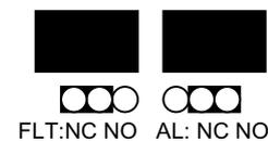
Jumpers para configurar relés de avaria e alarme como NF ou NA
