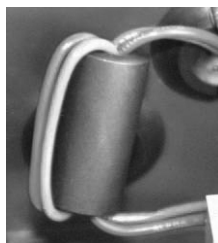
Figura 3-2: Núcleo de ferrite e condutores de alimentação
