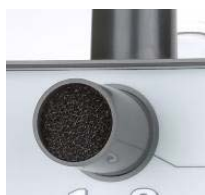
Figura 4-3: Filtro na entrada do sistema AutoSAT 10 sistema
