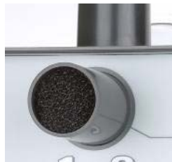
Figura 4-3: Filtro en la entrada del Detector AutoSAT 20
