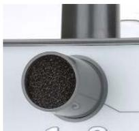
Figura 4-3: Filtro na entrada do sistema AutoSAT 20 sistema
