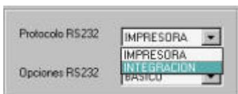
**-Impresora:** Conexión de impresora serie con dos opciones de control de datos:
