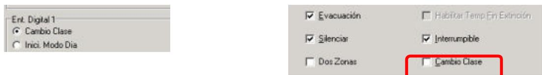
**1) Cambio de Clase.** (Disparo/Corte de Sirenas) Al realizar un cortocircuito sobre esta entrada, se producirá la activación de los módulos de control asociados a matrices de control de alarma o entrada de equipos en alarma que tengan esta opción habilitada en su matriz asociada. (Cambio de Clase). Al reponer el contacto se desactivarán.
