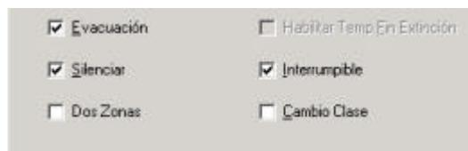
**-Evacuación:** Si se marca permite la activación del equipo con la matriz asociada, si es tipo ID Sirena (**SIR**), cuando se active la Evacuación en el Sistema.
