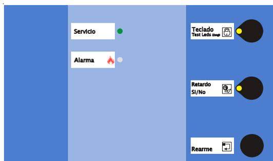
Pressionar **Rearme** para alterar o funcionamento do led Anulada com atraso
