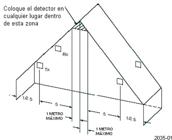
Figura 3. Techo inclinado (Tipo plano)
