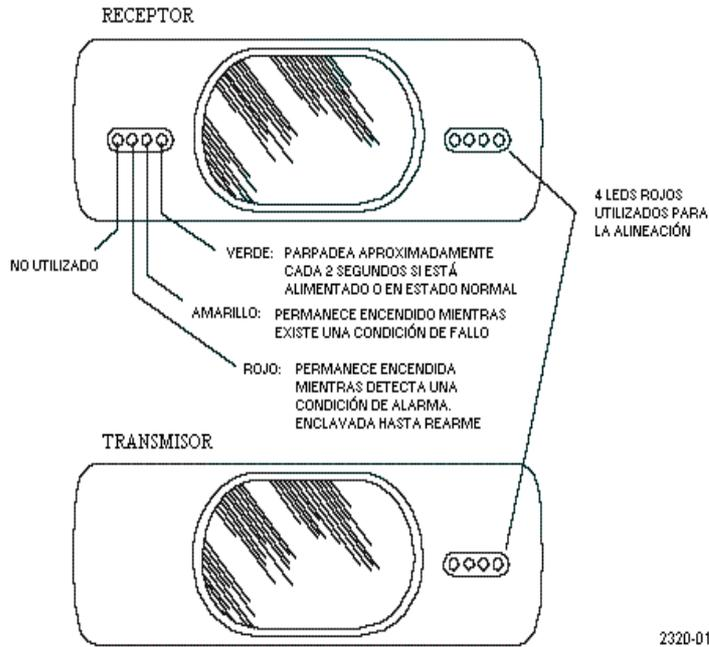
Figura 16. Vista Frontal del Transmisor y Receptor
