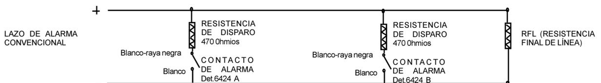
La figura 9 muestra las salidas remotas para fallo y alarma del detector Mod.6424 para conectar anunciadores remotos con LEDs.
