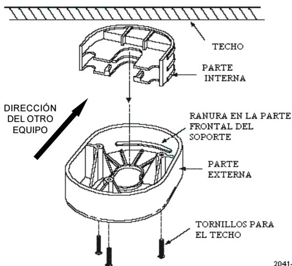
Figura 6. Conjunto de Soporte para montaje en techo
