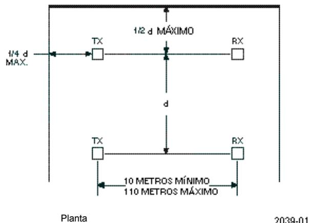
Figura 1. Separación para techos lisos (Vista lateral)
