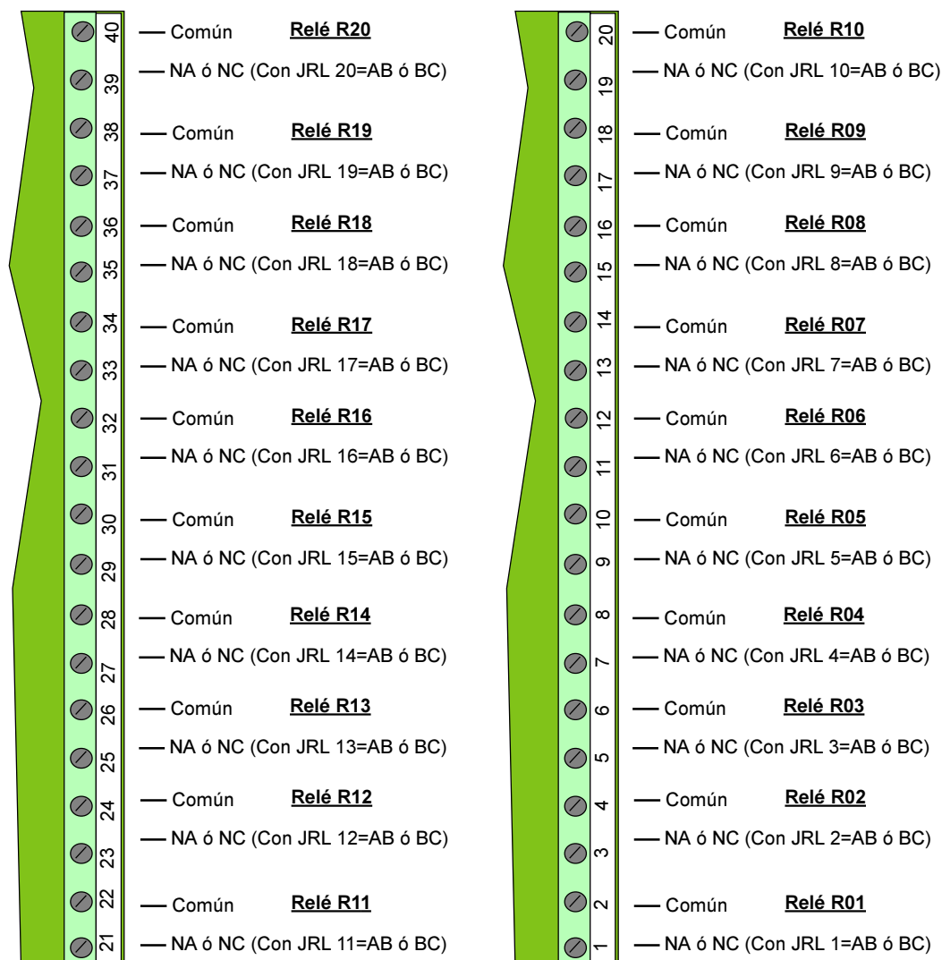
Figura 3 Conector CN2 de contactos de Relés y configuración NA/NC
