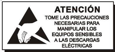
**PRECAUCIÓN:** Los circuitos electrónicos de la central ZX50 utilizan equipos con tecnología CMOS que pueden dañarse debido a descargas estáticas. Se **DEBEN** tomar las precauciones pertinentes cuando se manipulen las placas del circuito.
