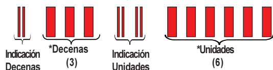
Figura 4 COMPROBACIÓN DE DIRECCIÓN (EJEMPLO DE PARPADERO DEL LED DEL EQUIPO Nº 36)
