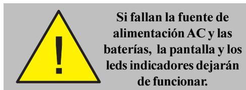
La pérdida de alimentación hace que el panel entre en condición de Fallo de alimentación. Esta condición se confirma con la iluminación del led de FALLO ALIMENTACIÓN, el led de FALLO general y la activación del zumbador interno. La pantalla se mostrará lo siguiente:
