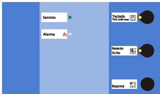
Presionar **REARME** para cambiar el funcionamiento del led Anulada con retardo
