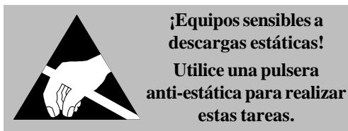
Los componentes electrónicos de estos paneles utilizan equipos con tecnología CMOS que pueden dañarse debido a cargas estáticas. Se deben tomar las precauciones pertinentes, como por ejemplo utilizar una pulsera conductiva con conexión a tierra siempre que manipule las placas de circuito.
